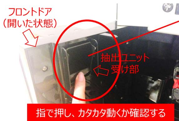
フロントドア内側の「抽出ユニット受け部」を押して「カタカタ」と動くか確認して下さい。動かない場合は、内部の汚れ固着が考えられます。指で何度か押してみても、固着が解消されるかお試し下さい。動くようになったら、フロントドアを閉め、内部洗浄ボタン
