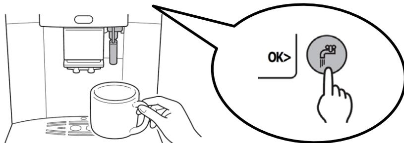
ポンプが空吸いしていることが考えられますので、給湯をして空気抜きを行います
