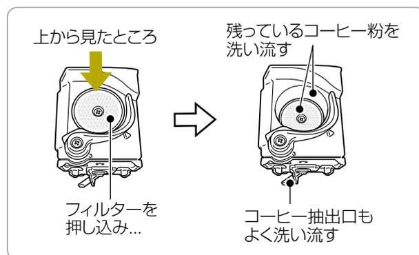
※食器用洗剤や研磨剤、漂白剤は使用しないでください。フィルターに付いたコーヒーの油分が金属の表面に膜を作り、金属臭を抑えます。
