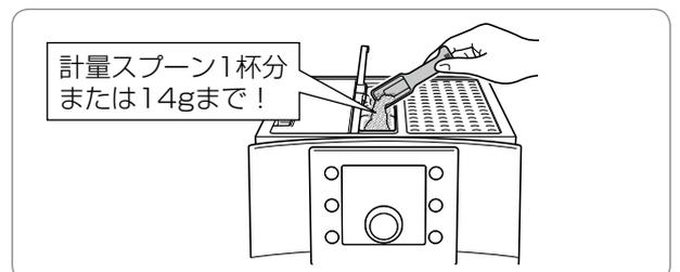
※電源オフ時にコーヒー粉を入れないでください。粉が本体内部に散り故障の原因になります。
