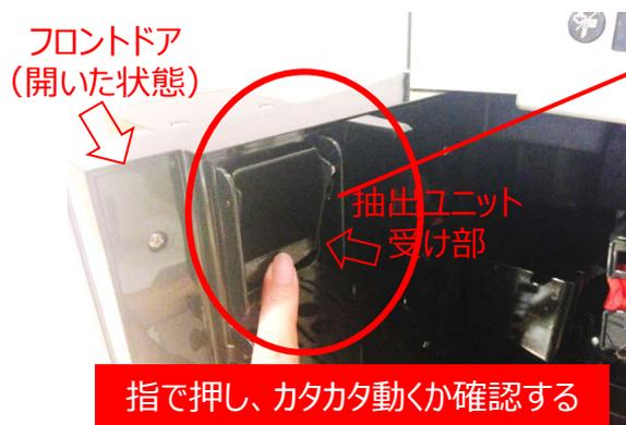
フロントドア内側の「抽出ユニット受け部」を押して「カタカタ」と動くか確認して下さい。動かない場合は、内部の汚れ固着が考えられます。指で何度か押ししてみて、固着が解消されるかお試し下さい。動くようになったら、フロントドアを閉め、内部洗浄を行ってください。
